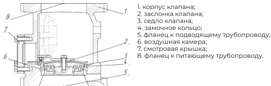
Рис.1 Конструкция клапана
