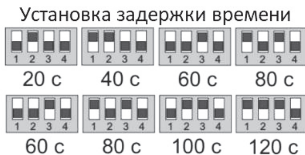
Рис. 4 Схема установки времени задержки с помощью DIP-переключателя
