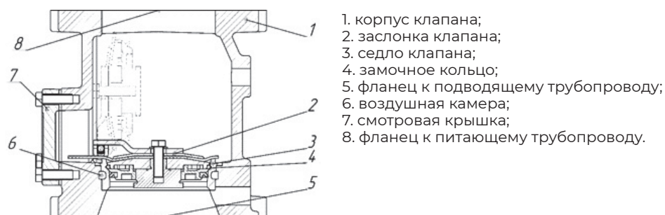
Рис.1 Конструкция клапана
